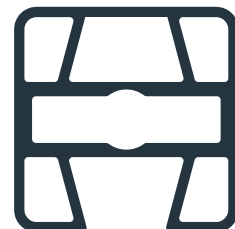
Pfostenmaße P60/1 Anfangs-/Endpfosten 60x60 mm
