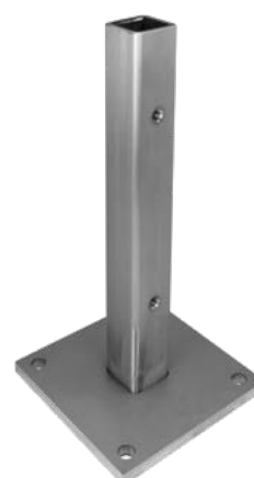
Grundplatte 150x150x10 mm Dornhöhe H=300 mm
