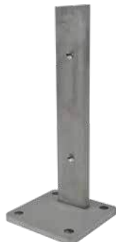
Grundplatte 120x120x10mm Dornhöhe H=300mm
